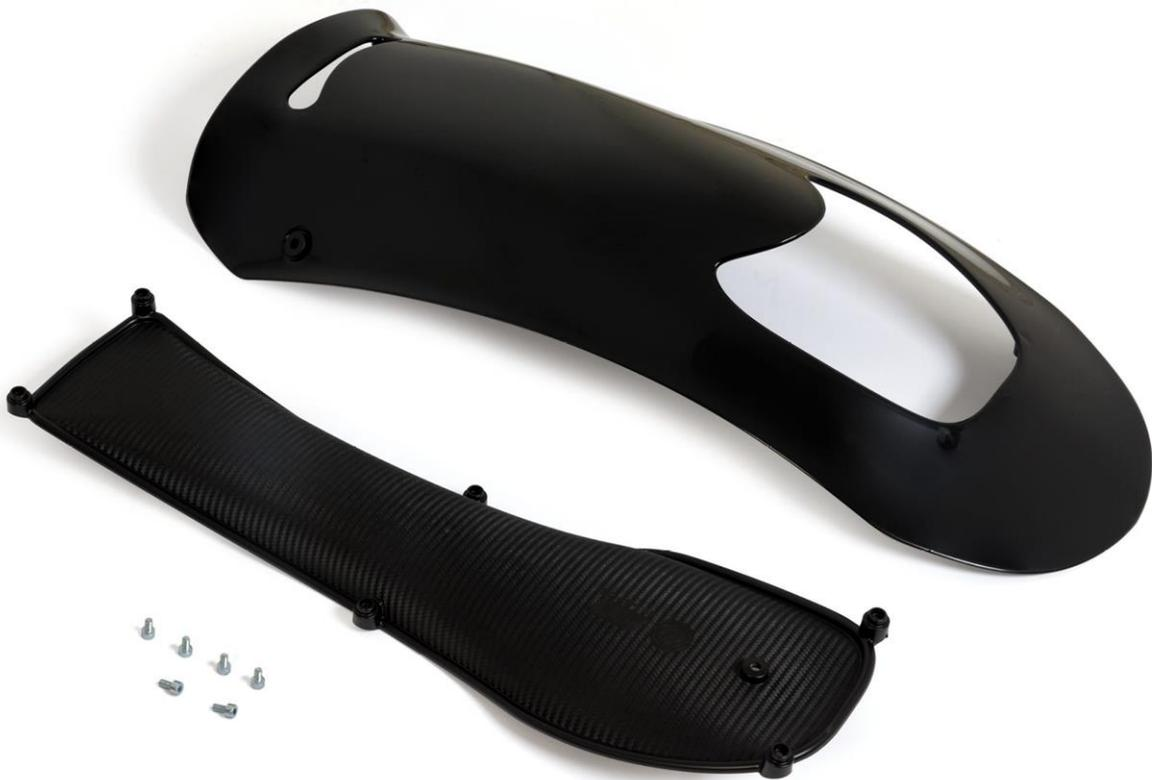
KG 社があらたに公認(CIK2022～)を取得した新型フロントパネル”508”は、気体や流体の流れを絞ることにより流速を加速させ、ドライバーが風圧をうけるエリアに圧力(気圧)の低い部分を作り出すベンチュリ効果を狙い新たに設計されました。
