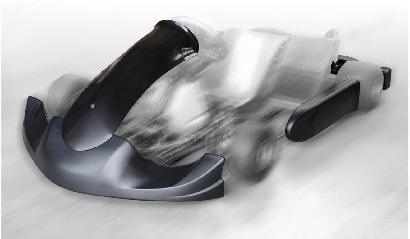
KG 社があらたに公認(CIK2022~)を取得した新型フロントパネル”507”は、ベンチュリ構造を持たないフロントパネルとしては、最も空気抵抗が発生しにくい構造をCFDシミュレーションにより導き出し、設計されました。
